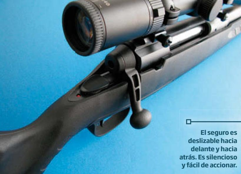
□ El seguro es deslizable hacia delante y hacia atrás. Es silencioso y fácil de accionar.
